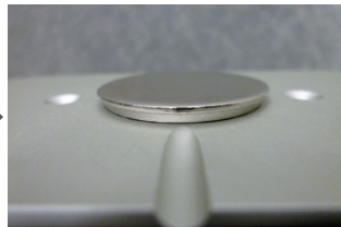
02：フィッティング ジグ上板にマグネットキーバーを装着する。平らな面をマグネット側へ装着する。
