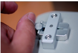
08：固定レバーを外側へ止まるまで引き、上板がガタつかないことを確認する。
