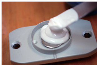
03：ボクシングリングをセットし石膏泥を満たす。(推奨：低膨張石膏)
