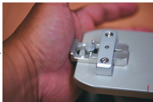
09：石膏硬化後固定レバーを解除する。
