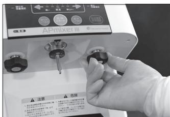
②エア抜きが必要とされる側のエア抜きバルブを開放します。
