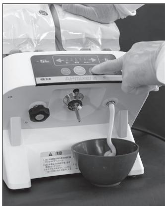
③エア抜き口の下にラバーボウル、ティッシュ等を置き、気泡を含まないペーストが出るまでエア抜きスイッチを押します。この時、手の平で、パック上部（底側）からパックのノズル側に向けパックを押し付けると、ペーストが吐出し易くなります。
